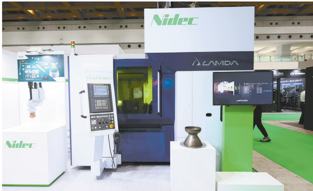
航空宇宙部品加工や金型補修をターゲットにしたAM機「LAMDA500」(日本電産マシンツール) AM machine LAMDA500 targeting aerospace parts processing and mold repairing (Nidec Machine Tool)
