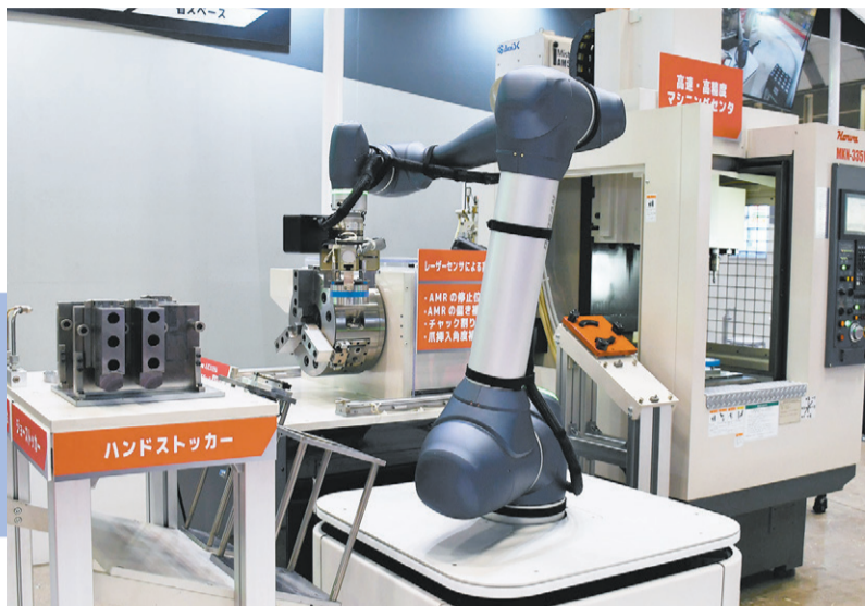
豊和工業のAMRによる加工ラインの自動化デモ Demo of automated machining line with Howa Machinery's AMR
