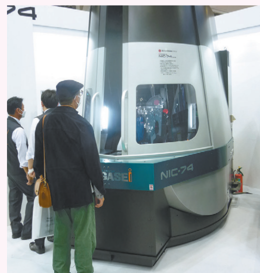
消費電力と設置面積を10分の1にしたナガセインテグレックスの同時6軸微細形状加工機「NIC-74」
