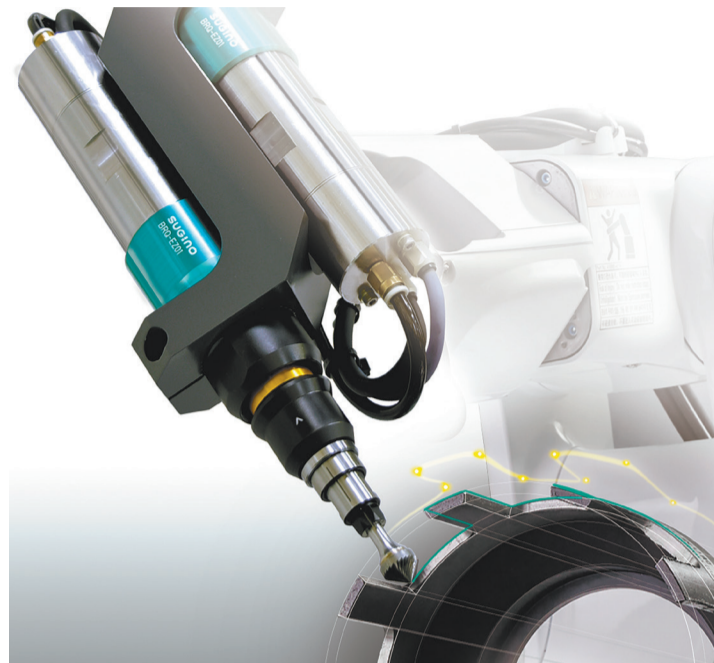
BARRIQUANスピンドルモータータイプ BRQ-EZ01 (スギノマシン提供) Barriquan spindle motor type BRQ-EZ01 (courtesy of Sugino Machine)
